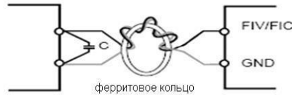
Схема подключения двухпроводного датчика давления 4...20мА с питанием 24 В постоянного тока с фильтрацией сигнала
