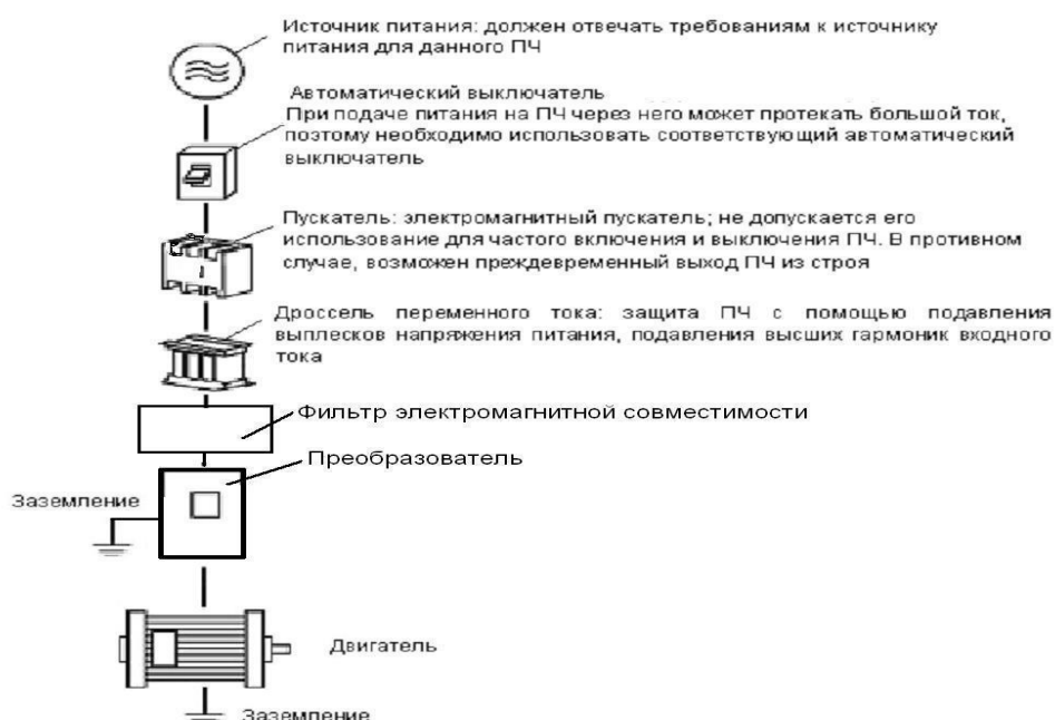
Схема электромонтажа силового контура
