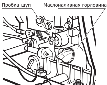
Рис. 2 Заполнение масляного картера
