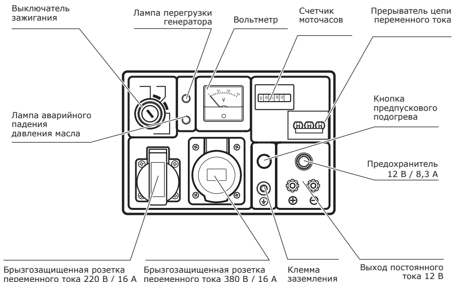
Рис. 3. Схема панели управления генератора УГД-6000ЕТ/4 кВт, УГД-7500ЕТ.
