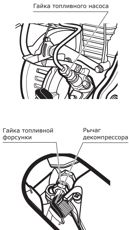
Рис. 11 . Удаление воздуха из топливной системы двигателя
